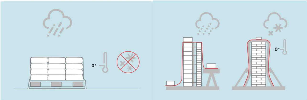
In Ziff. 4 ist der Begriff „frisches Mauerwerk“ interpretationsfähig. Um eindeutige Aussagen zu diesem Punkt machen zu können, sind Untersuchungen erforderlich. Tastversuche lassen derzeit den Schluss zu, dass einen Tag altes Mauerwerk (mit Dünnbettmörtel) nicht mehr unmittelbar gefährdet ist.
